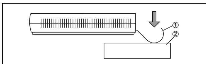
Die Meßelektroden ① des Gerätes werden beim Meßvorgang auf das zu messende Material ② gedrückt, damit ein hochfrequentes elektrisches Feld das Material durchdringen kann. Ein Mikroprozessor empfängt die Meßsignale und ermittelt aus dem Meßwert den durchschnittlichen prozentuale Wassergehalt.
