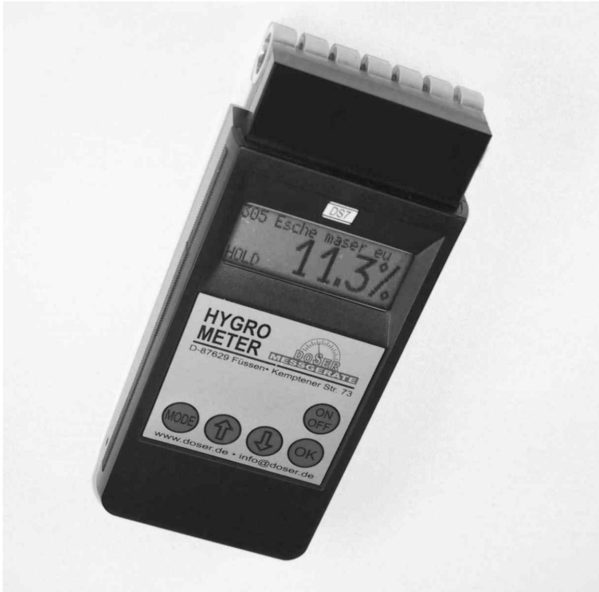
Das DS7 ist ein Messgerät zur Bestimmung der Furnierfeuchtigkeit in Furnierstapeln
