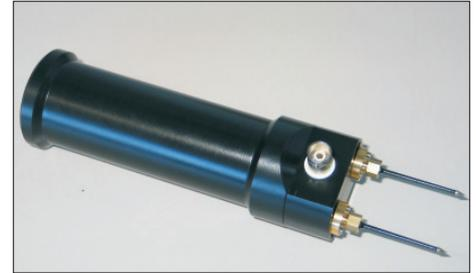
**Federelektrode** mit einseitigen oder beidseitigen Federelektroden, optimale Anpassung an unebene Flächen, ideal zur Messung von Feuchte in dünnen Platten, Furniere, Pappen, ...
